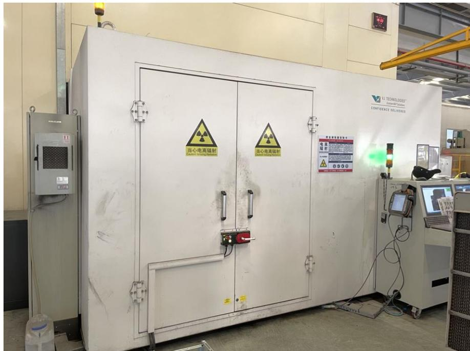
图6-1 检测铅房操作位、防护门
